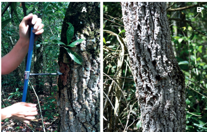
Figura 3. Metodologia de extração de amostras de madeira do tronco das árvores por método não destrutivo: extração com trado incremento com 5 mm de diâmetro (A e B).
